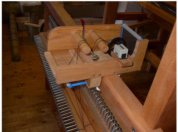
Fadenführgerät mit Zählwerk Einzug- und Auszugwebblatt sowie Gatterkamm zur Fadenkreuzbildung
