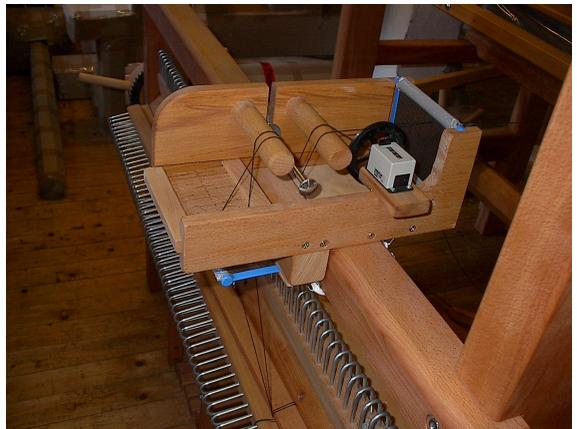
Fadenführgerät mit Zählwerk
