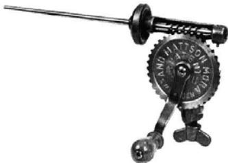
**Handspulmaschine für zylindrische Spulen**
